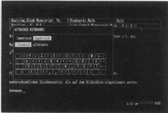
T3 unterstützt acht Zeichensätze mit je vier Tastaturbelegungen, die man jederzeit zur Kontrolle auf den Schirm rufen kann.
