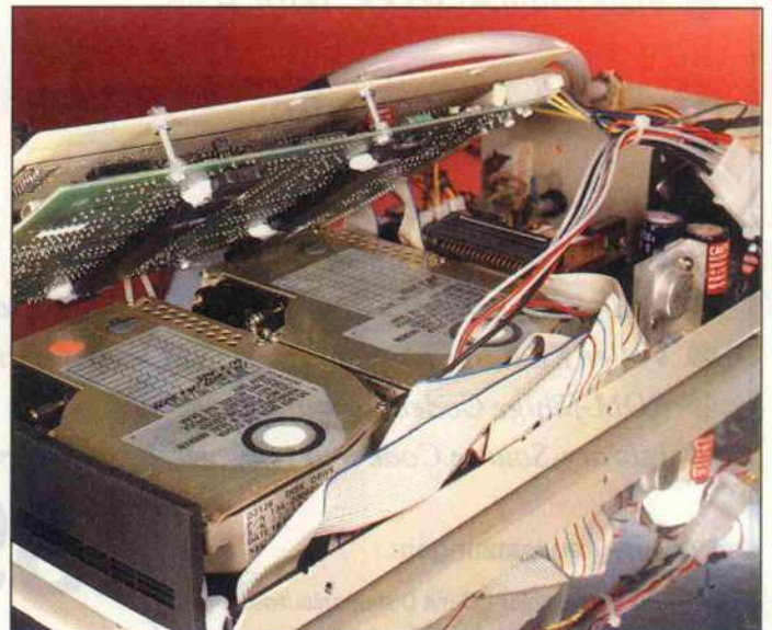
Zwei 3,5"-Festplatten stellen eine Kapazität von 21 MByte bereit, durch Datenkompression werden daraus 66 MByte.
